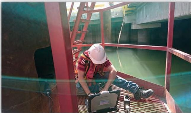
Pour mémoire le paramètre essentiel dans cet essai est la mesure du temps de propagation. A partir du moment où la continuité du pieu est assurée, ici par des chemisages métalliques, il n'est pratiquement pas possible de détecter des non conformités.
