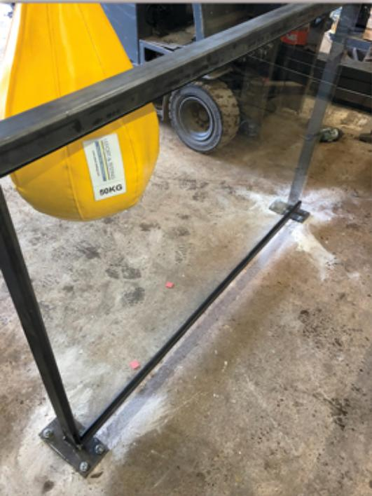
> Pour justifier des performances mécaniques des garde-corps, les fabricants effectuent des calculs qui doivent être validés par des essais dynamiques.
