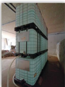
> Rincenc Île-de-France Sud a réalisé un essai de chargement lourd d'un quai de chargement du collège situé à Mantes-la-Jolie. Ce quai reçoit des camions et les essais simulent la présence d'un camion de 16 t sur la zone.
