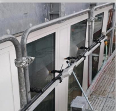
> Rincenc Île-de-France Nord a réalisé des essais d'étanchéité à l'eau sur les vitrages d'un immeuble de grande hauteur.
